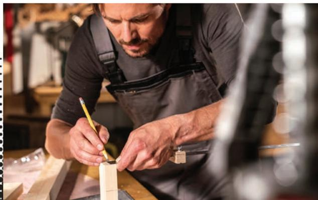
Jetzt bohrst du in jede Leiste, die hinten an die Regalböden kommt, je drei Löcher. Hier wird das Regal später an die Wand gedübelt. Dann folgen vier Bohrungen in der unteren Leistenhälfte, um sie am Regalboden anzuschrauben.
