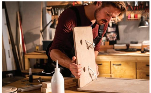
Jetzt gibst du in die Leim-Nuten einer Seitenwand Holzleim und steckst als Erstes die Stirnplatte mit dem Gesicht in eine kurze Nut. Dann machst du mit der Bodenplatte weiter und gibst auch auf die untere Kante der Stirnplatte einen dünnen Leimstrang. Zum Schluss montierst du genauso die zweite Stirnplatte. Mit einem Gummihammer und einem Zulage-Holz klopfst du die Platten in die Leim-Nut, sodass sie bündig zueinander sind.
