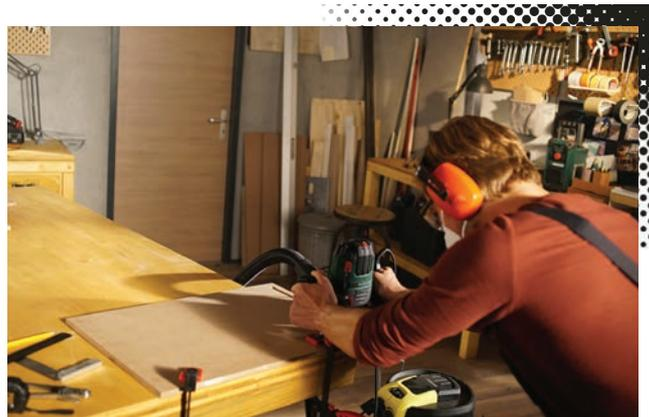
Jetzt fräst du vom Endpunkt der Nut für den Boden – parallel zur späteren Vorder- und Hinterkante der Seitenplatten – mit 18 mm Kantenabstand bis genau 30 mm unter der späteren oberen Plattenkante die Leim-Nuten für die Platten an den Stirnseiten. Beim Start den Fräskopf am linken Ende der Nut eintauchen.
