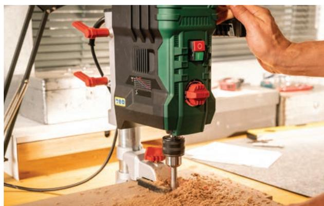
Jetzt fehlen nur noch zwei 15-mm-Bohrungen mit dem kleinen Forstnerbohrer, durch die später das Zugseil befestigt wird. Sie werden so positioniert, dass sie 105 mm Abstand zur Seitenkante und 185 mm Abstand zur Unterkante haben.
