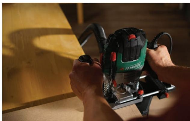
**Tipp:** Zeichne die Nut vor dem Fräsen präzise auf die Platte, besonders Start- und Endpunkte sind wichtig für das Ergebnis. So hast du immer eine Kontrolle, ob die Fräsung noch „auf Linie“ ist. Damit sich die Platte während des Fräsens nicht bewegen kann, spannst du sie fest ein.
