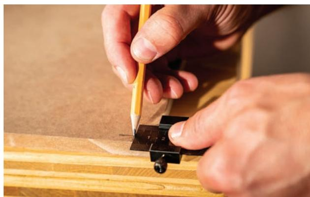
Die vordere Stirnseite bekommt jetzt die beiden „Augen“, deren Bohrposition jeweils 115 mm von oben und 105 mm von der Seite liegt. Nach dem Anzeichnen der Löcher spannst du einen 40-mm-Forstnerbohrer in die Tischbohrmaschine ein und bohrst behutsam durch die Platte.
